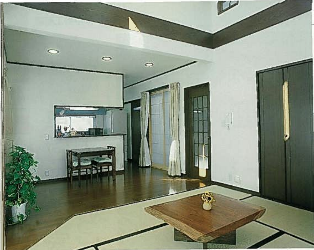
左/南面に確保したワンルームには畳コーナーを設置。吹き抜けの大空間は家族団らんの場。床：化粧合板フロア、一部畳、壁：クロス、天井：クロス
