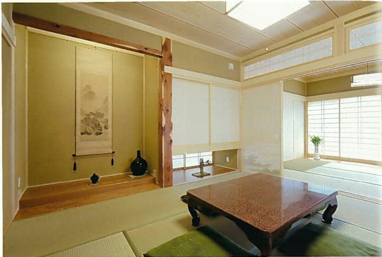
玄関横に設けられた和室の続き間。実用性を兼ねた床脇は、収納下からやわらかな外光を呼び込む。柱は持山から伐り出した檜4寸角。
